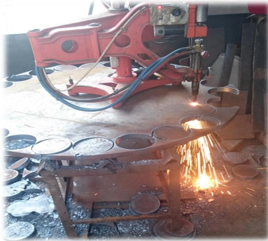
**Fabricación de bridas especiales de 1" a 4" de espesor.**
